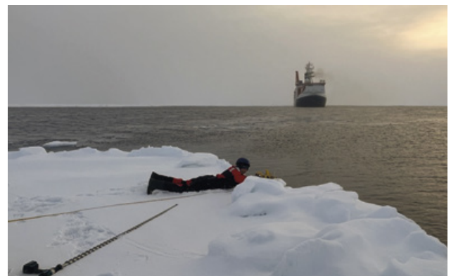
Abb. 3: Carolin Mehlmann bei der Vermessung einer Eisscholle zur Kalibrierung eines hybriden Meereismodells.
