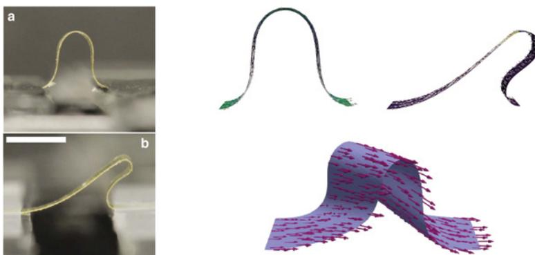
Abb. 6: Links: Symmetrisches und asymmetrisches Einknicken eines "normalen" und eines LCE-Films (Quelle: [19], Lizenz: CC BY 4.0). Rechts: FE-Simulationen basierend auf [18]; oben: Konfiguration ohne und mit vorgeprägter LCE-Orientierung; unten: Konfiguration mit tangential freier LCE-Orientierung.
