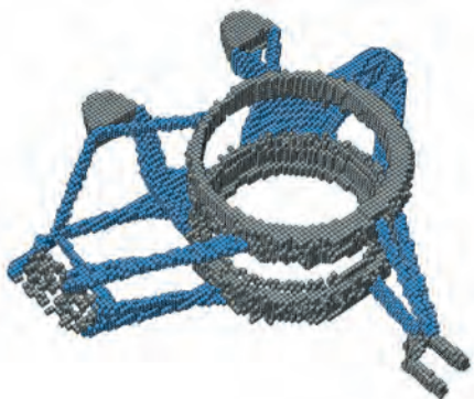
Topologieoptimierungs-Ergebnis eines Radträgers in Multi-Material-Bauweise.
