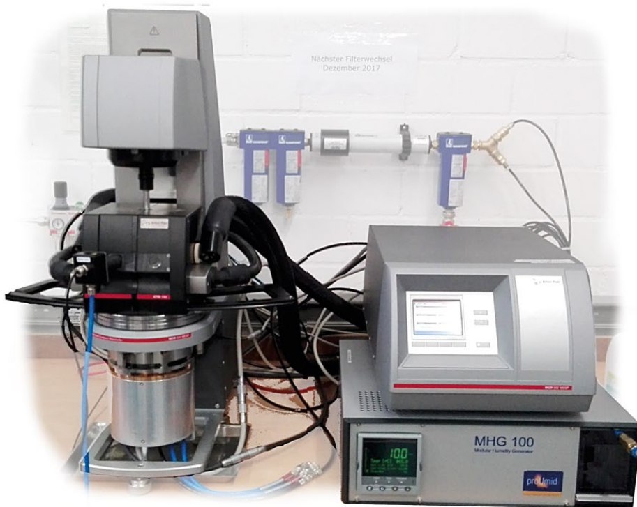
Abb. 5: Anton-Paar MCR 302 Doppelmotor-Rheometer für harmonische Zug- und Torsionsanregungen mit Temperatur- und Feuchtekammer (DMTA)
