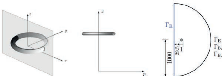
Abb. 3: Perspektive einer Ringspule (links), Ringspule in der r-z - Ebene (Mitte) und Abmessungen mit homogenen Dirichlet-Randbedingungen (rechts).
