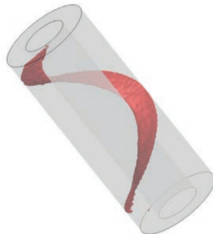
Abb. 3: Risspfad entlang einer hohlzylindrischen Probe unter Zugbelastung. Die helixförmige Ausbreitung des Risses resultiert aus der Anisotropie des betrachteten Materials und wird durch ein Phasenfeldmodell für Risswachstum in spröden anisotropen Festkörpern modelliert [6].
