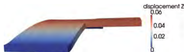
Abbildung 4: Optimale Verschiebung nach der Rückfederung, 100-fach vergrößert
