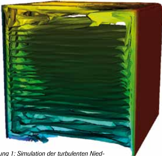
Abbildung 1: Simulation der turbulenten Niedrig-Machzahl-Strömung in einer Kavität - Temperaturisoflächen
