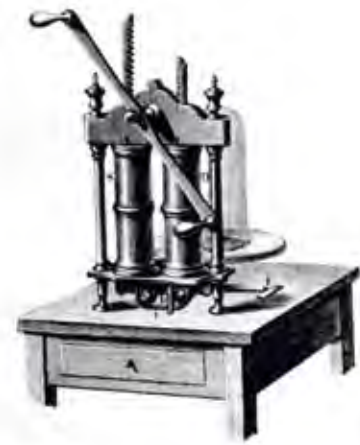
Abbildung 2: Eine zweistufige Pumpe [24]. "Derjenige Cylinder, in welchem der Kolben gerade aufsteigt, saugt Luft aus dem Recipienten, während in dem anderen Stiefel, in welchem der Kolben gleichzeitig niedergeht, die vorher aus dem Recipienten gesaugte Luft durch das Kolbenventil entweicht".
