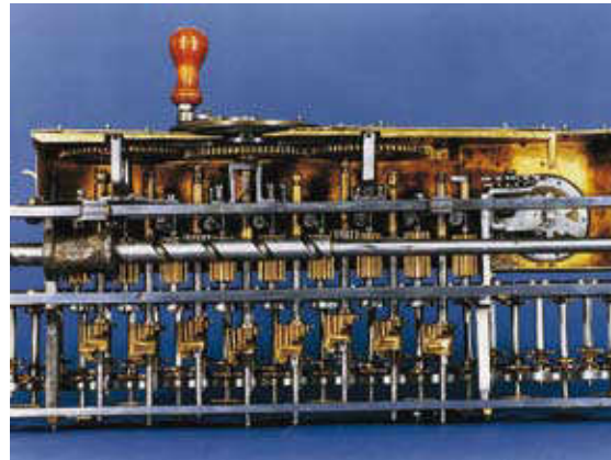
Bilder 1a,b: Fotos der letzten großen Leibnizschen Vier-Spezies-Rechenmaschine, gebaut ~1700 bis 1716
